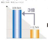
実物の1/3スケールモデルでの 実験(右の写真)により、 建築基準法に定められた 耐震数値の約3倍の耐震性
